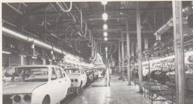
gänge werden hingegen in zwei verschiedenen Sektoren durchgeführt, und zwar in: — der Linie der synthetischen Lacke, die 500 Aufbauten in 15 Stunden schafft; — der Linie der Akrylharz-Lacke mit Metalleffekt, die in der Lage ist, 100 Aufbauten in 15 Stunden durchlaufen zu lassen.
